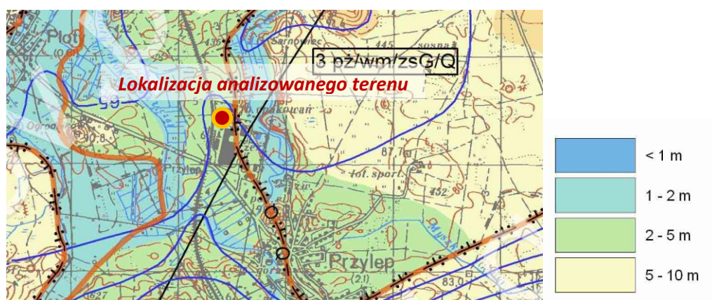
Ryc. 3 Głębokość do pierwszego poziomu wodonośnego
